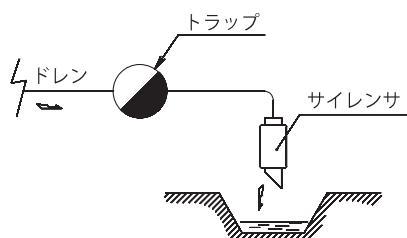
(ロ) 電磁弁の排気管に取り付けた場合
