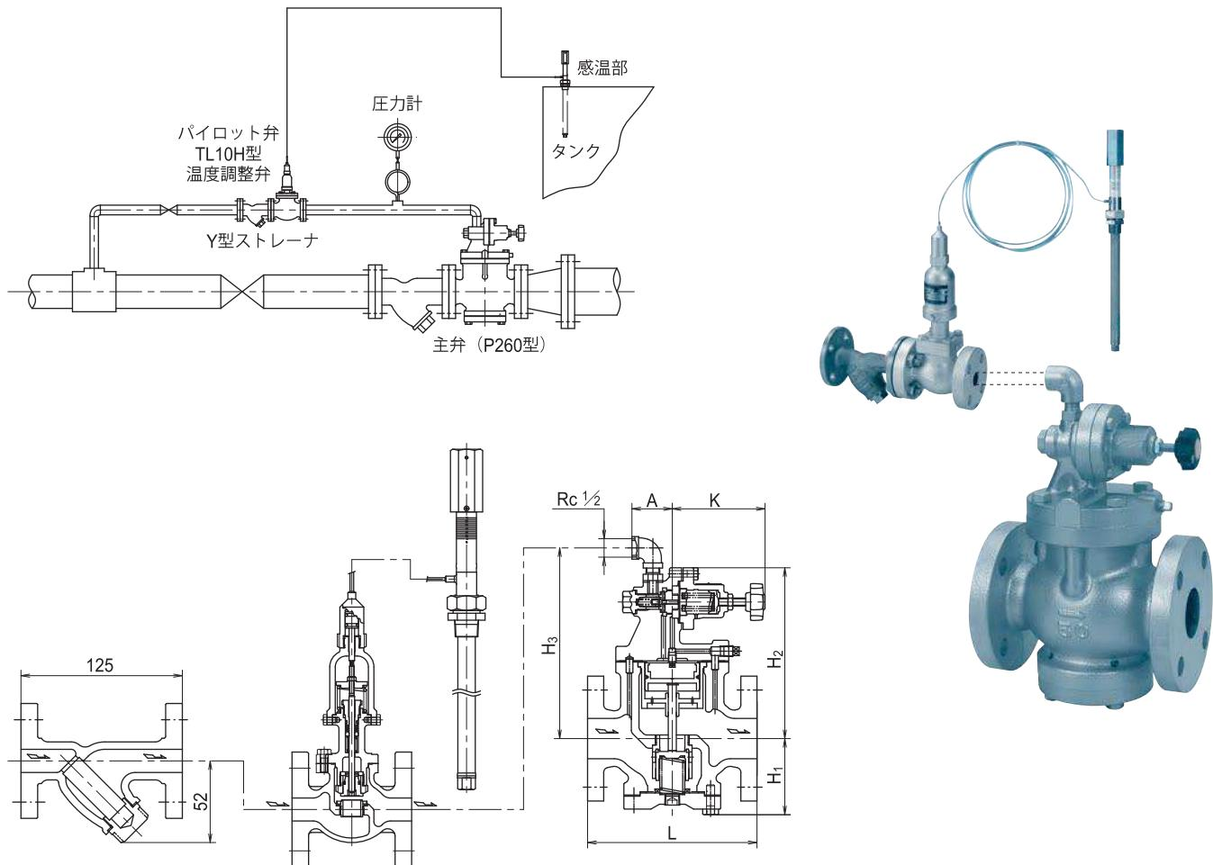
BW5型は、主弁のP260型減圧弁、パイロット弁のTL10H型温度調整弁とY型ストレーナで構成されています。
